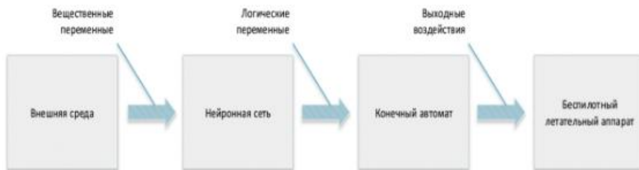
Рис. 2. Структурная схема системы управления БПЛА с применением генетического программирования.
