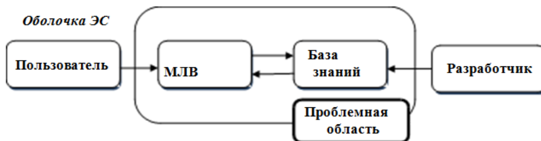
Рис. 1. Структура экспертной системы
